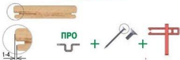
Комплектующие для монтажа террасной доски с асимметричным пазом
